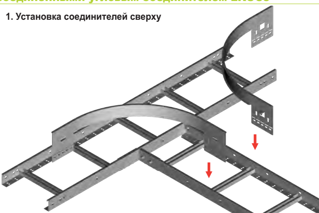
Приставной соединитель LDDKP3 (LDDKC3) подходит для кабельростов Н45.
