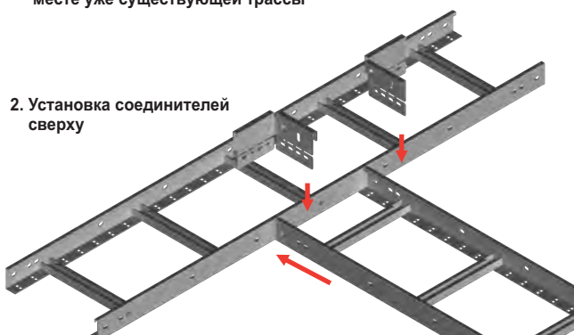
Угловой соединитель универсальный LKUC3 подходит для кабельростов Н45.
