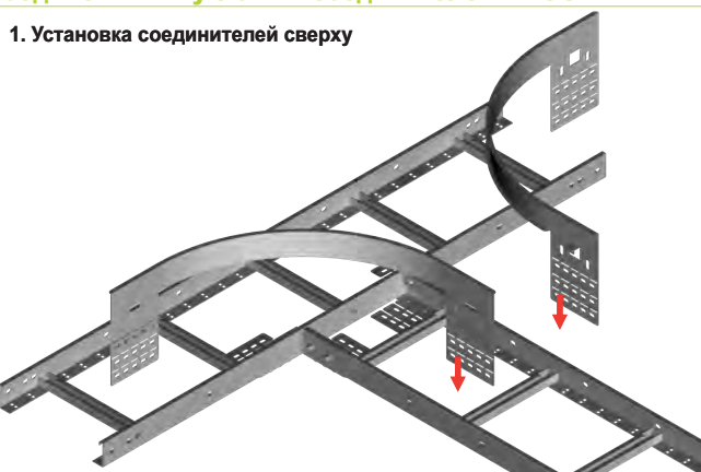
Приставной соединитель LDDKP1 (LDDKC1) подходит для кабельростов Н50, Н80 и Н120.
